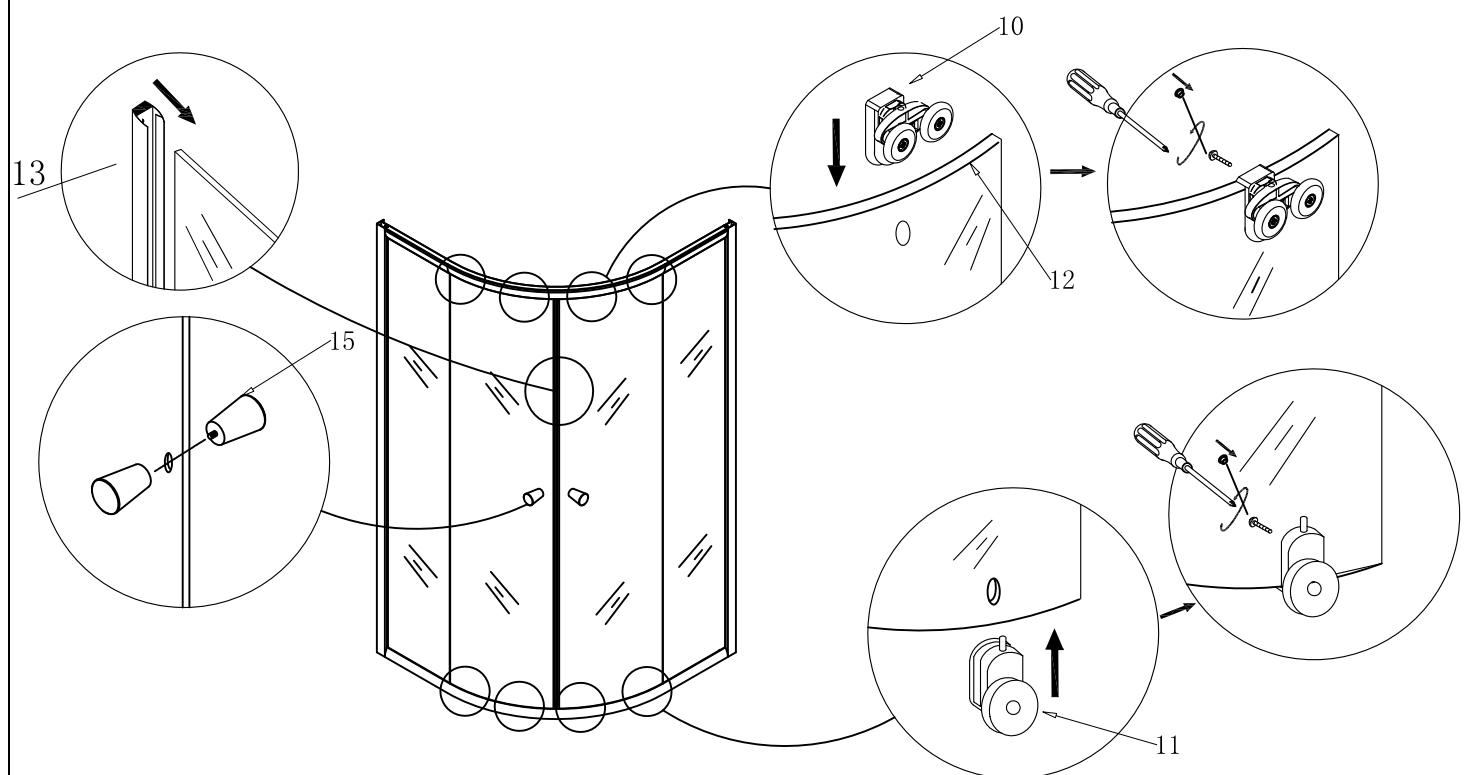
step5: 把房框子放到盆上, 再用水平尺打好水平, 用记号笔做好记号, 在用6mm钨钢钻打好孔, 孔内敲好膨胀管, 把房框子放到盆上, 对准膨胀管, 用4x30螺丝固定边铝材.
