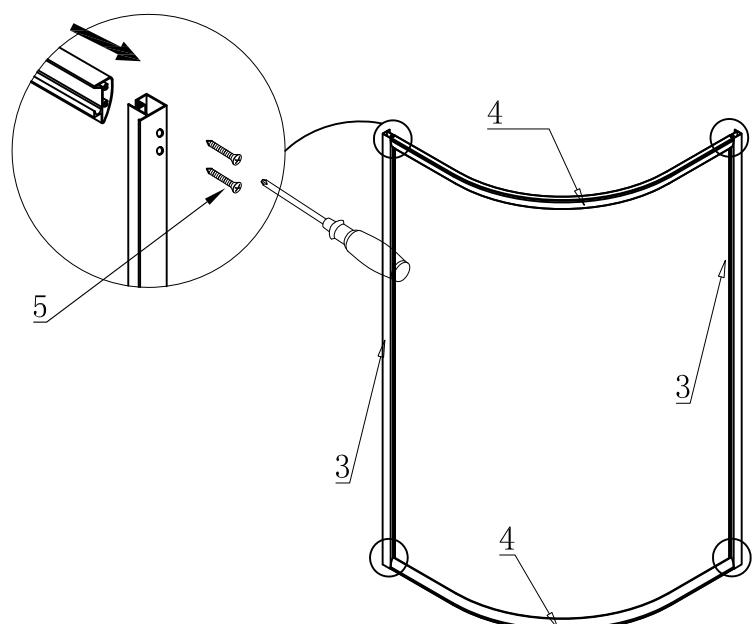
step3: 装上档门玻璃，把压片用4x10螺丝对准上下轨导拧紧，另一边也一样装好
