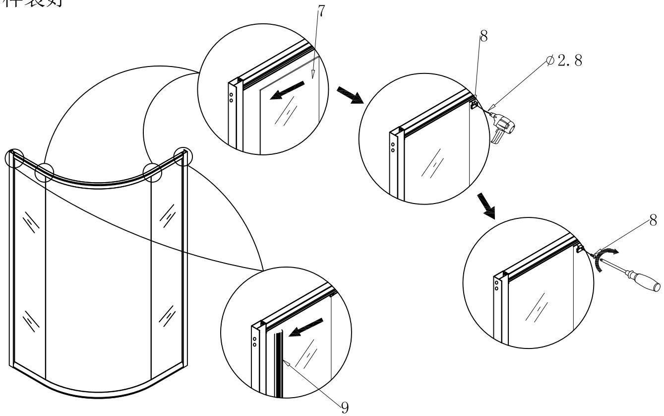
step4: 将弹跳双轮和单轮装到移门上，放到轨导上，装好吸条和拉手
